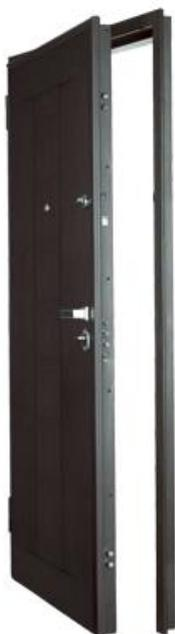
*La robustezza è garantita dalla struttura realizzata in doppia lamiera rinforzata con 3 omega verticali e 3 orizzontali di spessore 20/10.*
